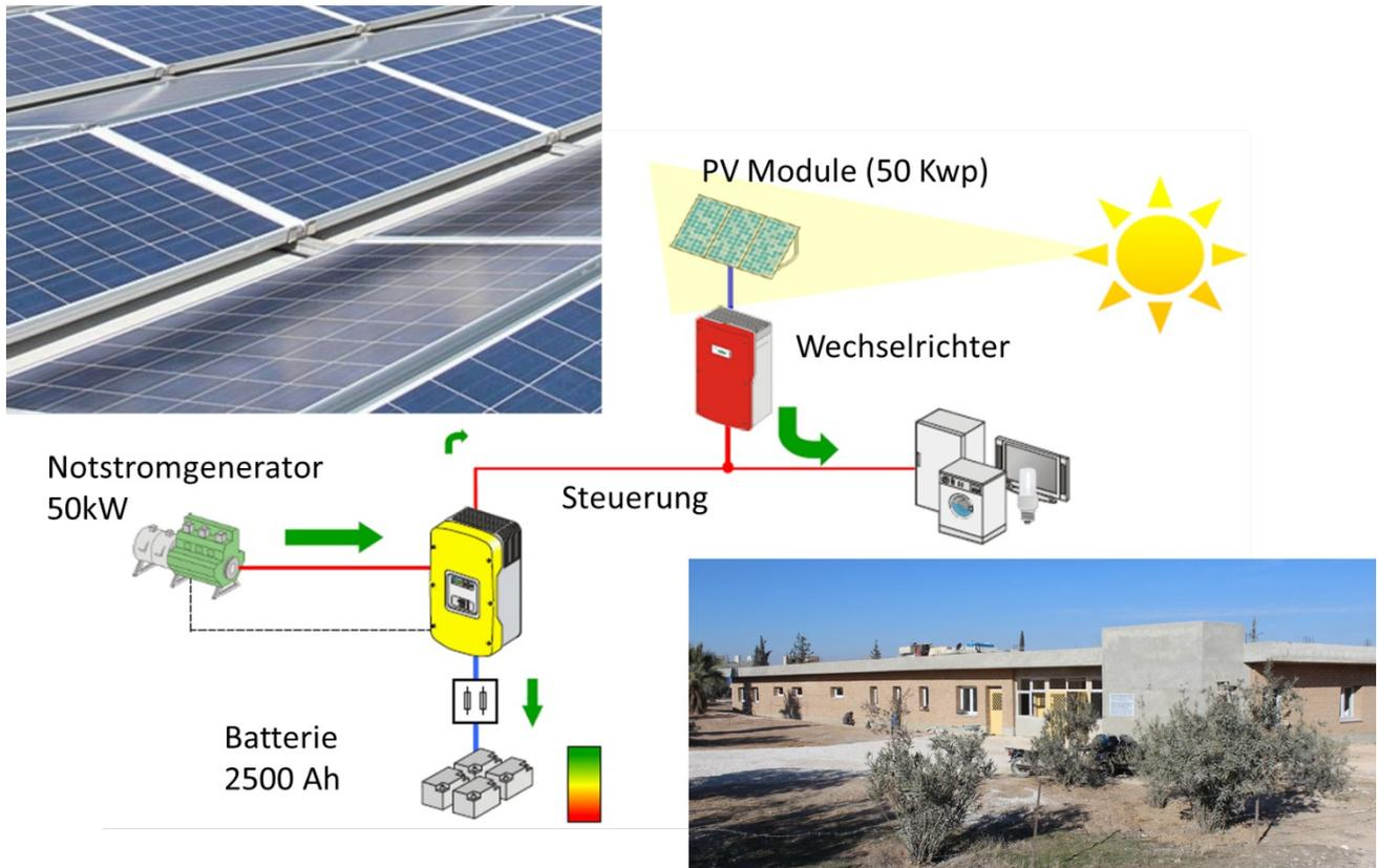
*Geplante Photovoltaik-Inselanlage mit Wechselrichtern und Speicher. Je nach Budget können bis zu 200 PV-Module mit 50 kWp installiert werden. Die Anlage soll auf dem Dach installiert werden und ermöglicht die Grundversorgung des Gesundheitszentrums mit elektrischer Energie.*
